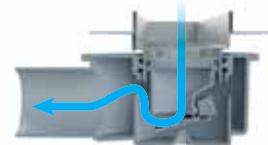
До тех пор, пока через сифон не протекает вода, заслонки находятся в закрытом положении и препятствуют проникновению запаха из канализации при высыхании мокрого гидрозатвора.
