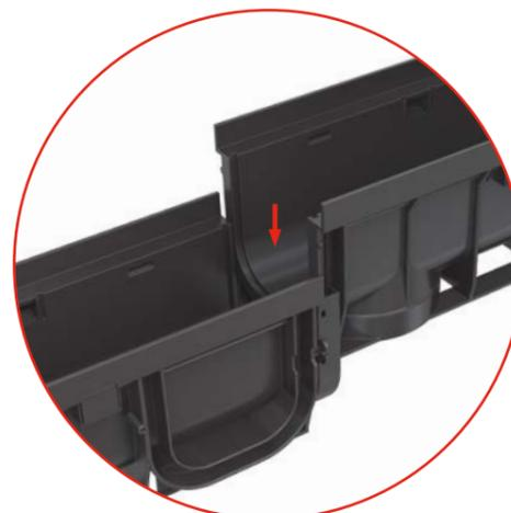
Корпус дренажного канала имеет с одного края выступ, а с другого – специальный паз. Попаданием в данный паз образуется надежное соединение между двумя каналами. Таким образом соединенные каналы сами держат линию.
