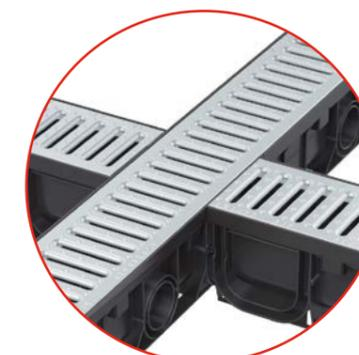
Модульная система подключения без необходимости дополнительных элементов. Это позволяет не только упростить установку, но и уменьшить финансовые затраты. Это также позволяет создавать соединения «I», «L», «T» и «X» – образные без дополнительных принадлежностей.
