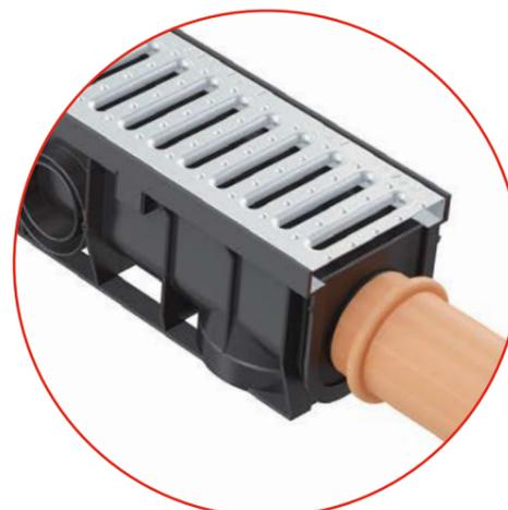
Для дополнительного подключения притока желоб имеет четыре подготовленных боковых отверстия, в которые можно установить трубу DN50. Вход DN75 и DN110 можно подключить спереди.
